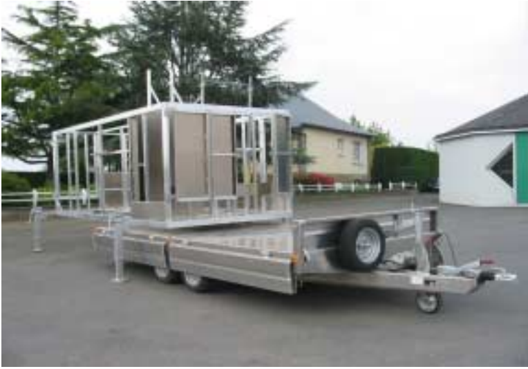
REMORQUE PLATEAU AVEC CONTAINER A ECHAFFAUDAGE AMOVIBLE
